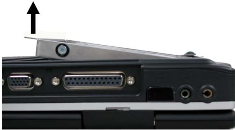
7. Zum Einbau der neuen Festplatte müssen Sie die Laschen der Festplattenhalterungen passend zu den Anschlüssen im Einschubfach ausrichten. Drücken Sie die Halterung sanft nach unten, bis sie einrastet. Wenden Sie keine Gewalt an, da sonst die Anschlusspins an der Festplatte verbogen werden könnten.
